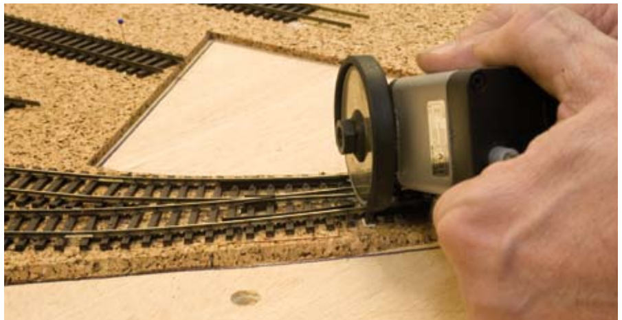
Oben: Mit einer Diamant-Trennscheibe werden die beiden Flügelschienen kurz vor dem Herzstück durchtrennt. Rechts: Die elektrische Verbindung zwischen dem abgetrennten Teil der Flügelschienen und dem Herzstück musste mit Draht wieder hergestellt werden.
