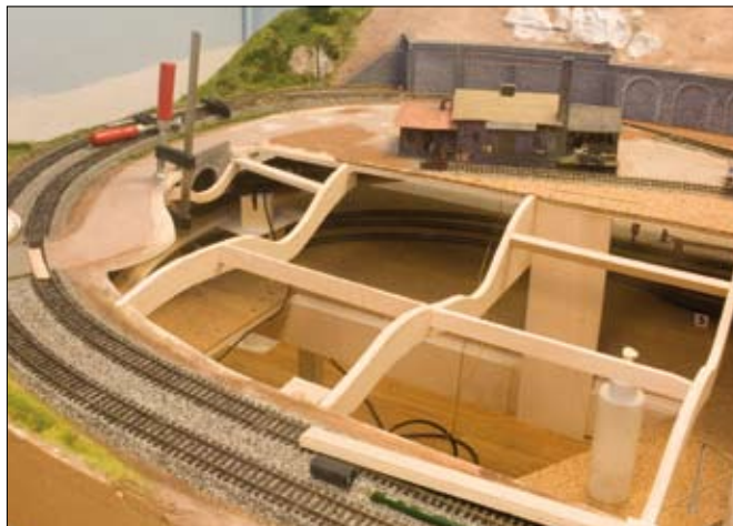
Die Sperrholzspannten haben einen Überzug aus Alu-Drahtgewebe erhalten.
